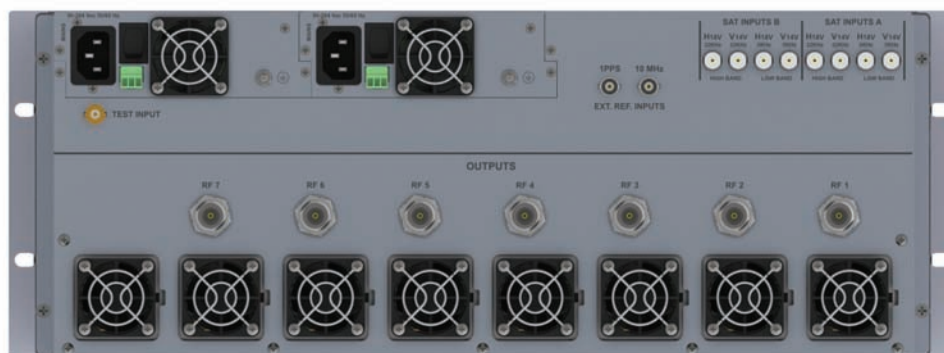
Panel trasero con doble fuente de poder redundante
